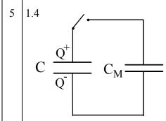
Die Ladung Q des Plattenkondensators wird mit dem ladungsempfindlichen Messverstärker gemessen. Im Messverstärker befindet sich ein Kondensator mit der Kapazität  $C_M$ . Bei der Ladungsmessung wird dieser Kondensator parallel zum Plattenkondensator mit der zu bestimmenden Kapazität C geschaltet (siehe nebenstehende Skizze). Damit nahezu die gesamte Ladung Q vom Plattenkondensator zum Kondensator im ladungsempfindlichen Messverstärkers abfließt, muss die Kapazität  $C_M$  groß gegenüber C sein.
